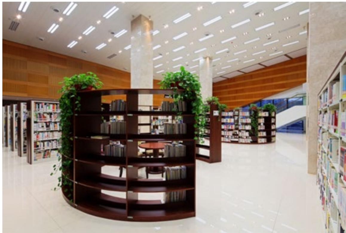
后，运至现场组装拼接就位。现场首先完成地面瓷砖铺设，再安装放置书架。吊顶为白色条形铝单板，用膨胀螺栓、吊杆吊件固定在上层楼板底。木质书架在专业木制品加工厂经过防火、防腐、防白蚁处理后，在面层涂刷环保型水基漆，透出木材本色。根据设计要求，书架整体验收标准应保证卯榫严密无松动，平整度、垂直度在可允许的误差范围内，漆面厚度一致无流淌痕迹。
